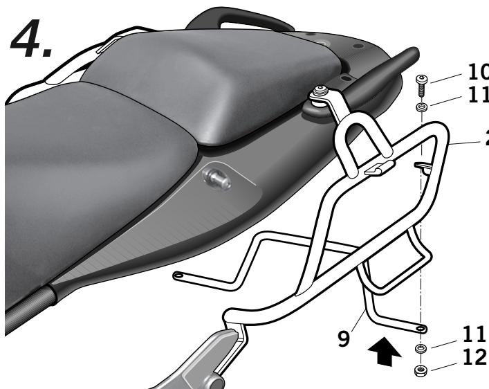
**E** Montar el puente unión (9) mediante los tornillos (10), las arandelas (11) y las tuercas (12).
