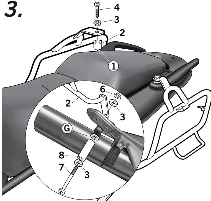
**E** Montar el soporte KIT SIDE (2) derecho en zona superior mediante el distanciador (1), la arandela (3) y el tornillo (4). Y en zona tubo de escape mediante el tornillo (7), el distanciador (8), la arandela (G), la arandela (3) y la tuerca (6).
